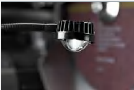
Светодиодный источник света на гибком креплении
