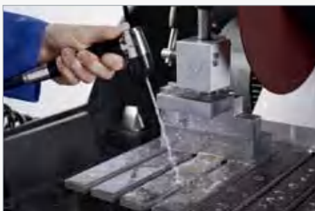
Промывочный пистолет, облегчающий очистку станка
